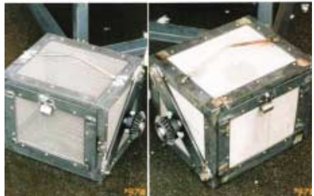
図6. 重油で汚染された砂礫を浄化する装置の全体像(上)と礫のための目のあらい網のバスケット(下左)と砂のための目の細かいバスケット. 1997年4月18日撮影。
