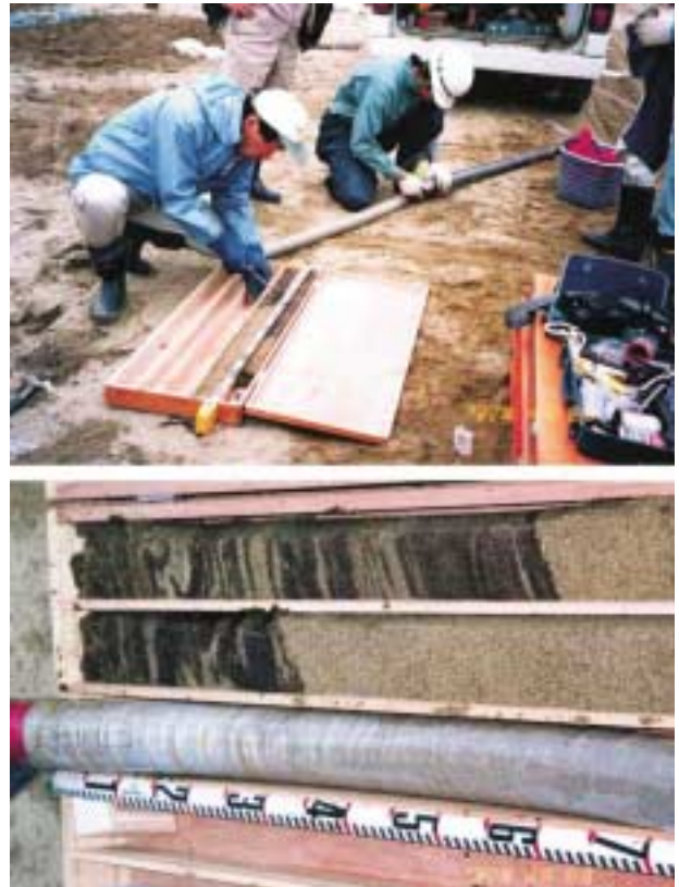
図 3. 加賀市浜地海岸におけるボーリング作業 (上) と 30-60cm の重油の層をもつボーリングコア (下). 1997 年 4 月 8 日撮影.
