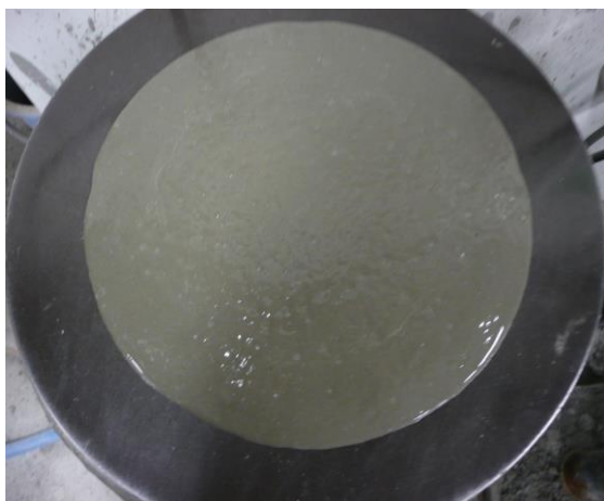
図 2-1 ワーカブルなセメントペーストの フロー試験結果の例 (CP1-④)
