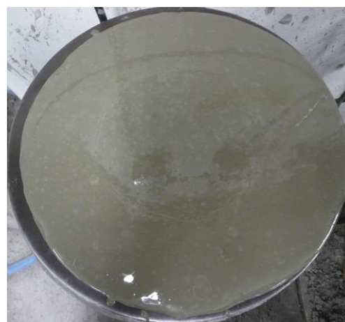
図 2-2 ワーカブルではないセメント ペーストのフロー試験結果の例
