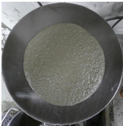
図2-4 ワーカブルなモルタルのフロー試験結果の例（M2-①） 図2-5 ワーカブルではないモルタルのフロー試験結果の例
