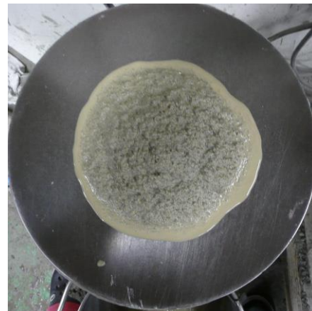
図2-4 ワーカブルなモルタルのフロー試験結果の例（M2-①） 図2-5 ワーカブルではないモルタルのフロー試験結果の例
