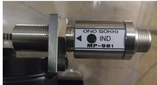
図 2-2-3 磁電式回転検出器
