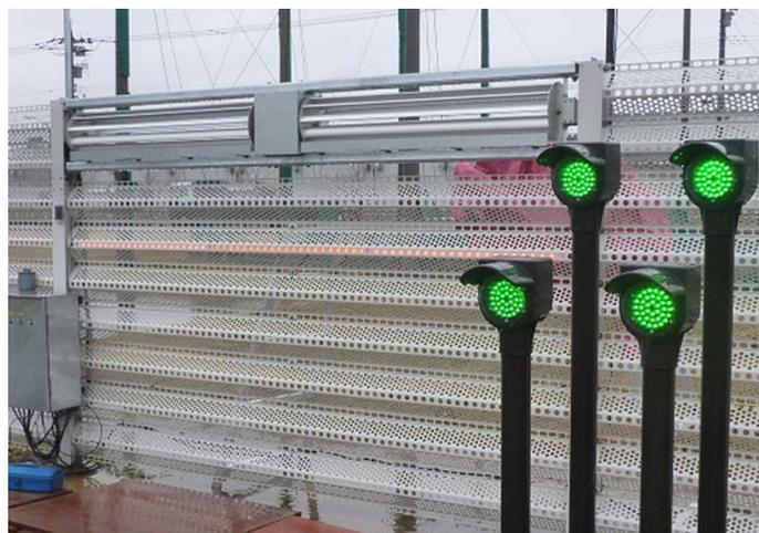
図 8-1-1 クロスフロー風車を設置した防風フェンスの概観
