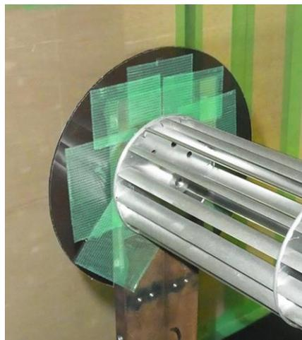
図 7-4-2 風車の端に設置した円形端板
