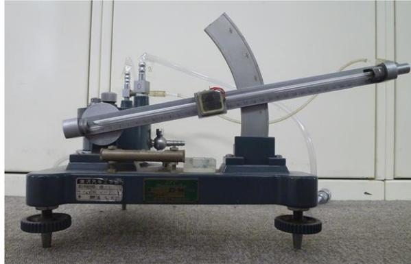
図 2-2-9 精密差圧計 (傾斜マンノメータ)
