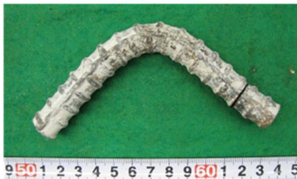
写真-3.10 曲げ半径測定に使用した鉄筋 (D16)
