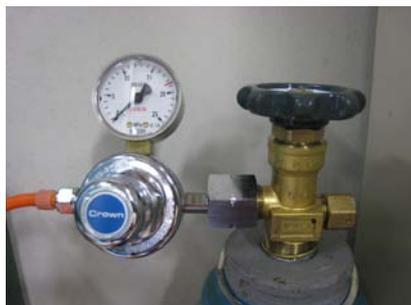
図-3.2.1.2 充填用ヘリウムガス
