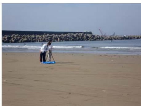
(ウ) レーザー測距計によるR.P.間の測距
