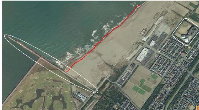
図-2.2.6.1 ハンディー型 GPS 測量による汀線測量（国土地理院に加筆）
