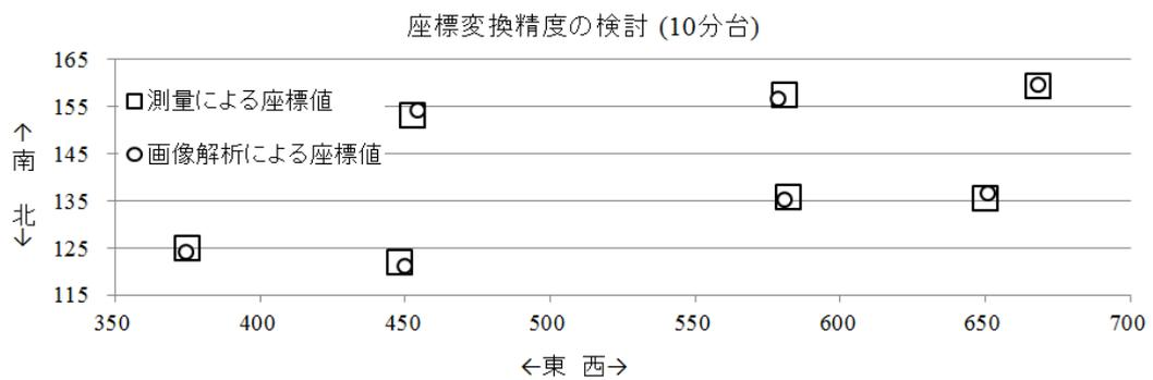
(エ) R.P.の測量による位置と座標変換後の位置
