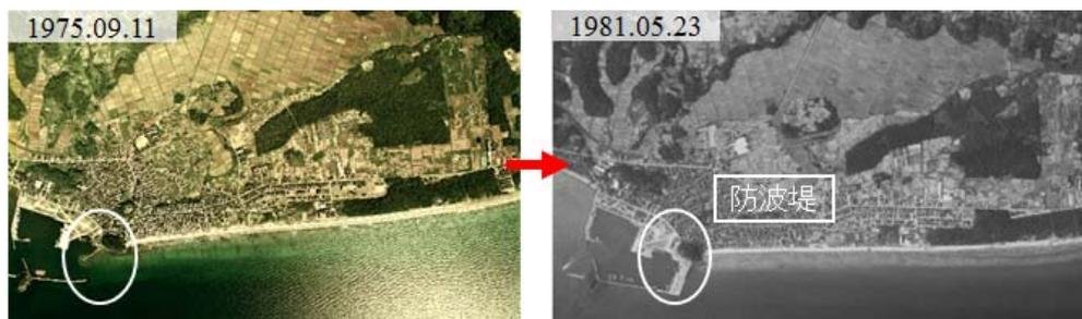
図-2.1.10.8 防波堤設置による汀線変動 (国土地理院に加筆)
