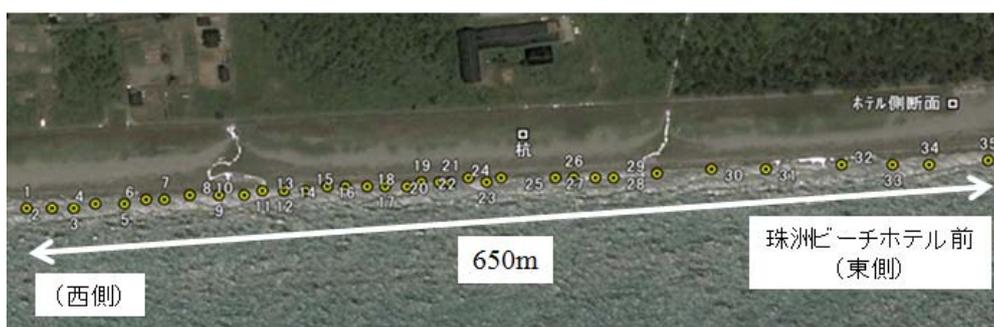
図-5.2.2 T.S.とGPSによる汀線測量地点 (Googleマップに加筆)
