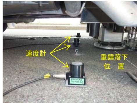
写真-4.3.4 重錘落下位置と速度計の配置状況
