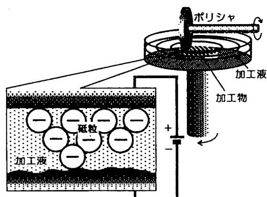
図1 電気泳動研磨の加工原理
