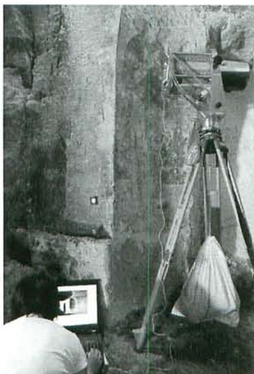
Fig. 4 三脚の真下に吊り下げられたおもり
