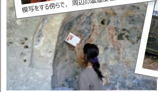
壁面色彩記録は、色差計によるデジタル測定と水彩絵具を用いたカラーサンプリング（アナログ記録）の2 wayで実施
