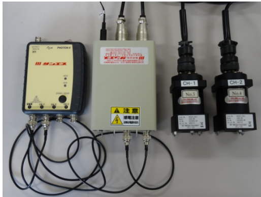
図-3 サーボ型加速度計関係の計器(右から加速度計, プリアンプ, リアルタイム音響振動解析装置)
