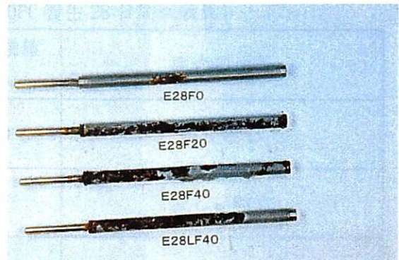
写真 4.11 鉄筋の腐食状態 (エコセメント 養生 28 日間試験体) (左から エコセメント単身、FA・A 20%、 FA・A 40%、FA・B 40%)
