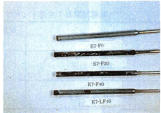
写真 4.9 鉄筋の腐食状態 (エコセメント 養生 28 日間試験体) (左から エコセメント単身、FA・A 20%、 FA・A 40%、FA・B 40%)
