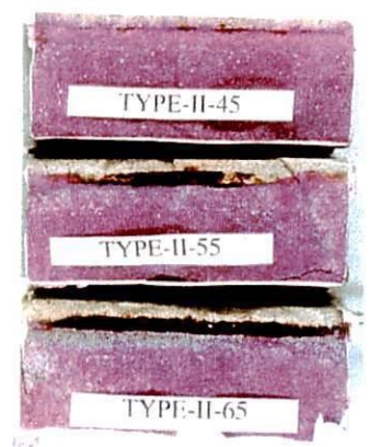
写真 3.5 中性化の様子 (低塩化物型) (上 : W/C=45%) (中 : W/C=55%) (下 : W/C=65%)
