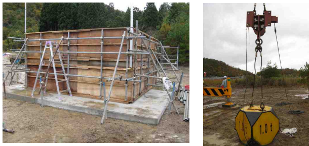
写真-1 重錘落下実験槽, 重錘と開放装置: SAEFL 規格準拠
