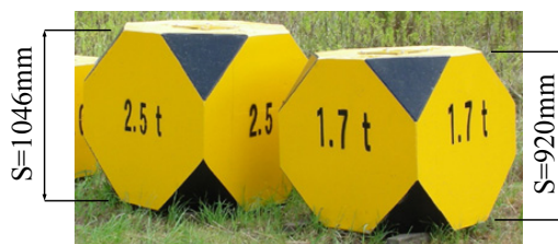
図-11 重錘の形状寸法
