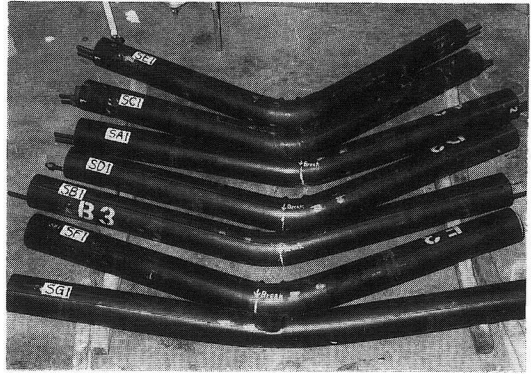
写真-1 静的荷重試験および試験後の供試体
