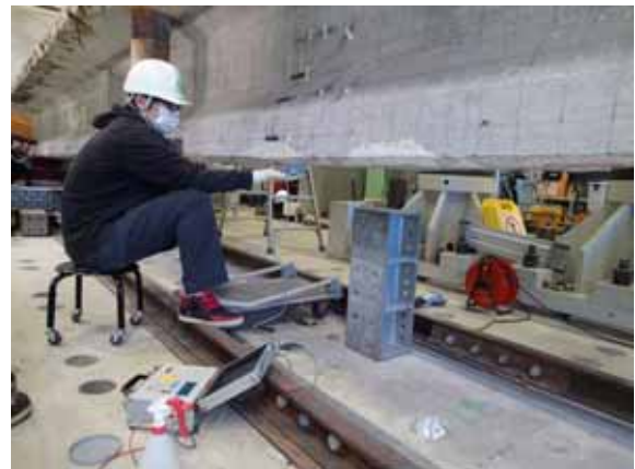
写真 3.2.4 分極抵抗の測定状況
