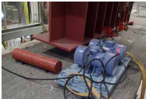
(c) 起振器による共振加振試験
