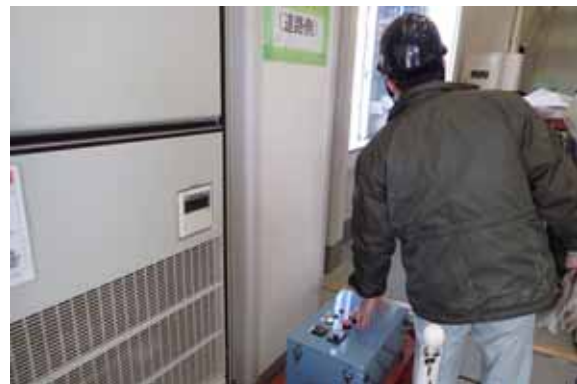
(d) 起振器による共振加振試験
