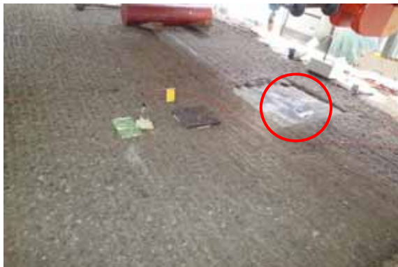
(c) ひずみゲージの設置状況（床版上面）
