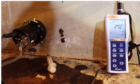
(a) ウェブ下端塩分測定(素地調整前)
