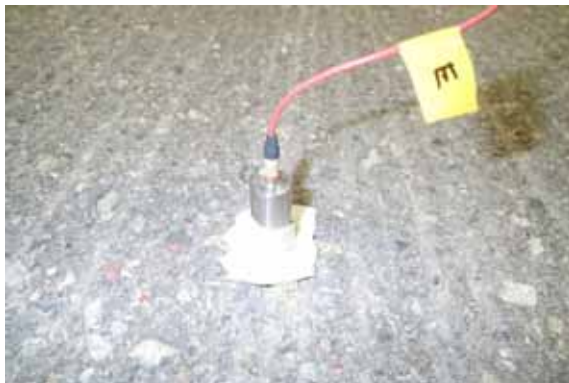
(a) 加速度計の設置状況
