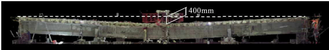
(b) 荷重荷重760kNの試験体の変形状況
