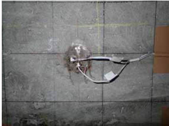
(a) ひずみゲージの設置状況
