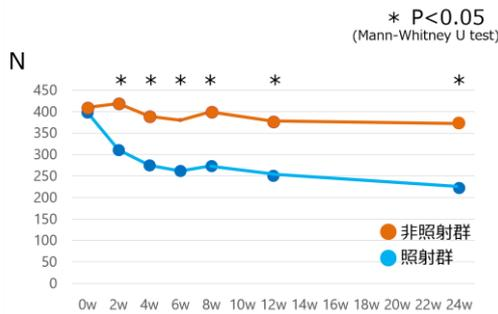
図 7 椎体圧縮負荷試験の結果
