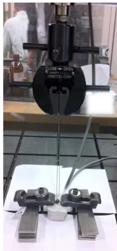
図 4 スクリューの引き抜き試験
