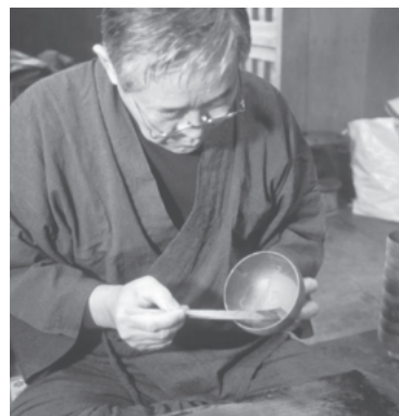
木地を堅牢にする下地工程
