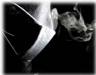
図3 マスク装着時の白煙漏れ挙動
