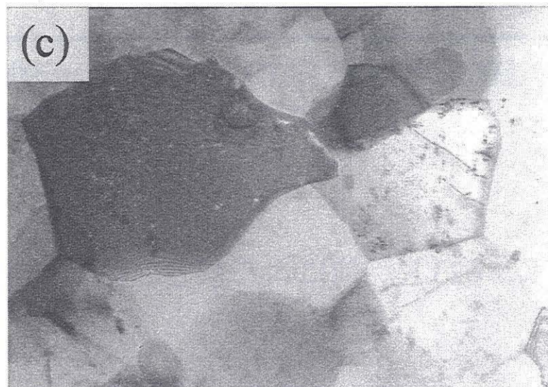
図2 (a) ECAE材, (b) 573 Kで10 min焼鈍材, (c) 573 Kで60 days焼鈍材のTEM像.
