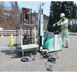
開発した衝撃荷重載荷試験機
