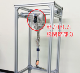
股関節部分を動力化した試作義足
