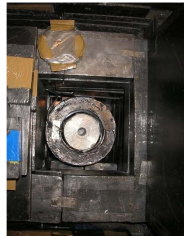
写真 2 上から見た測定器と鉛遮へい。白く見える円形が直径 9.6cm の井戸型検出器。周りの円周状の囲いが金沢城の鉛
