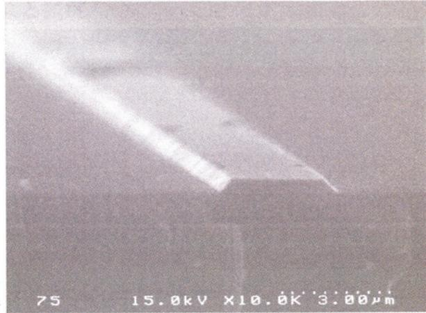
図 4.12: ドライエッチングにより作製したデバイスの SEM 画像
