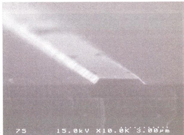
図 4.12: ドライエッティングにより作製したデバイスの SEM 画像
