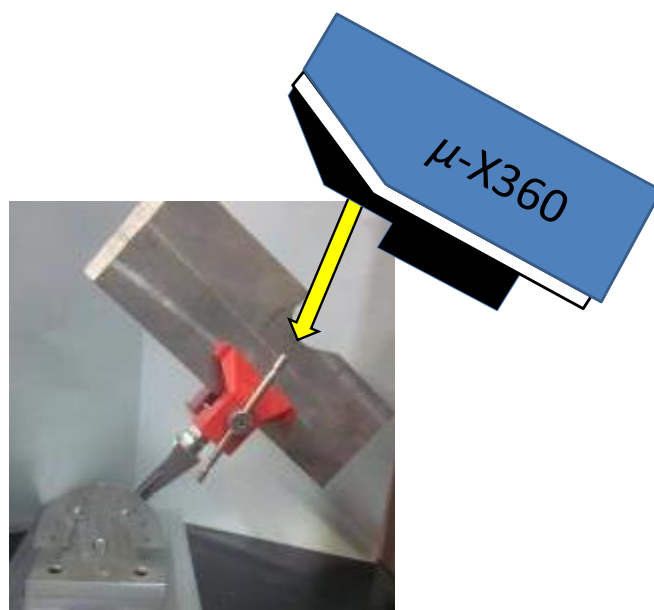
図 5-1 T 片のフィレット表面側の応力測定イメージ図
