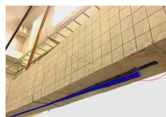
図3 CFSで補強されたRC梁
