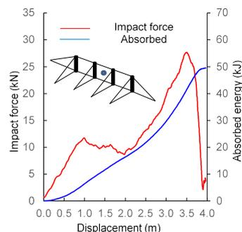
図4 フェンスの衝撃力とエネルギー吸収
