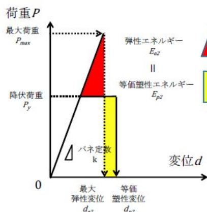
図5 最大変形の推定法概念図
