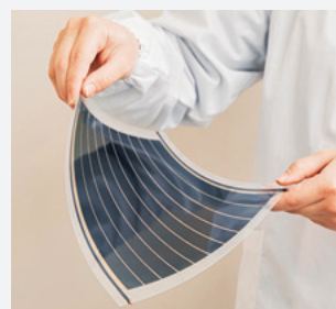
軽くて曲がる特性を持つ有機薄膜太陽電池
