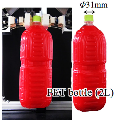
Figure 3-36. 重量物かつ複雑形状物体である物体の把持
