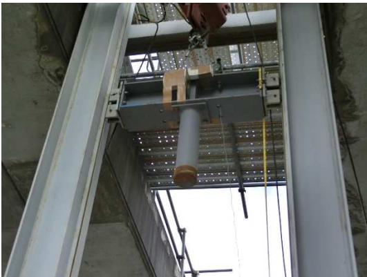
写真 2-2 重錘形状 (157.0kg 時)
