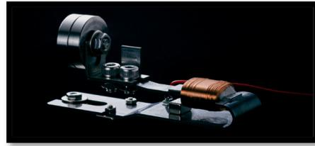
写真-2 磁歪式振動発電デバイス
