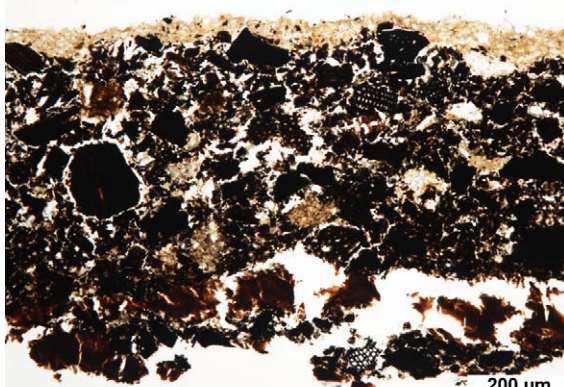
写真 27 同上の塗膜断面（透過光）
