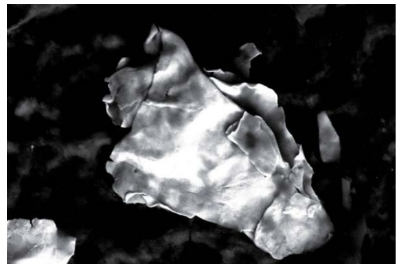
図 103 描金部分の漆断面 (SEM)
