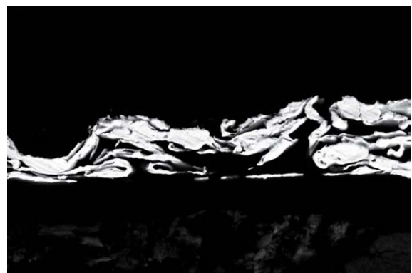
図 99 描金部分の漆断面 (SEM)
