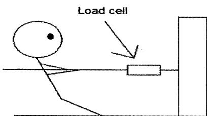
Figure 2 牽引力の測定
