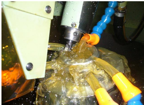
図 1-1 金属加工プロセスにおける切削油の使用例
