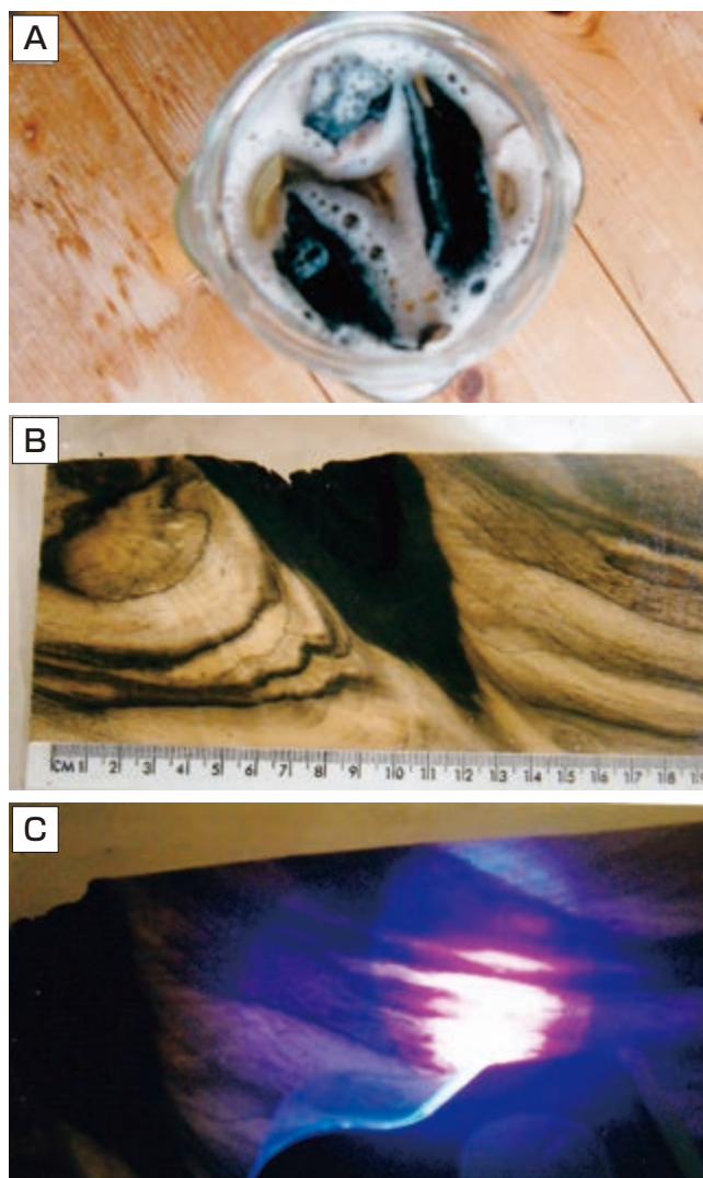
第 5 図 黒柿の簡単なチェック方法; 過酸化水素実験 (A), ミネラルライト照射実験 (B, C)。B の黒色部に紫外線をあてた状態が C。 Fig. 5 Simple check methods of Kurogaki (Black persimmon); \text{H}_2\text{O}_2 checking for organics and bacteria (A), mineral light irradiation method (B, C).
