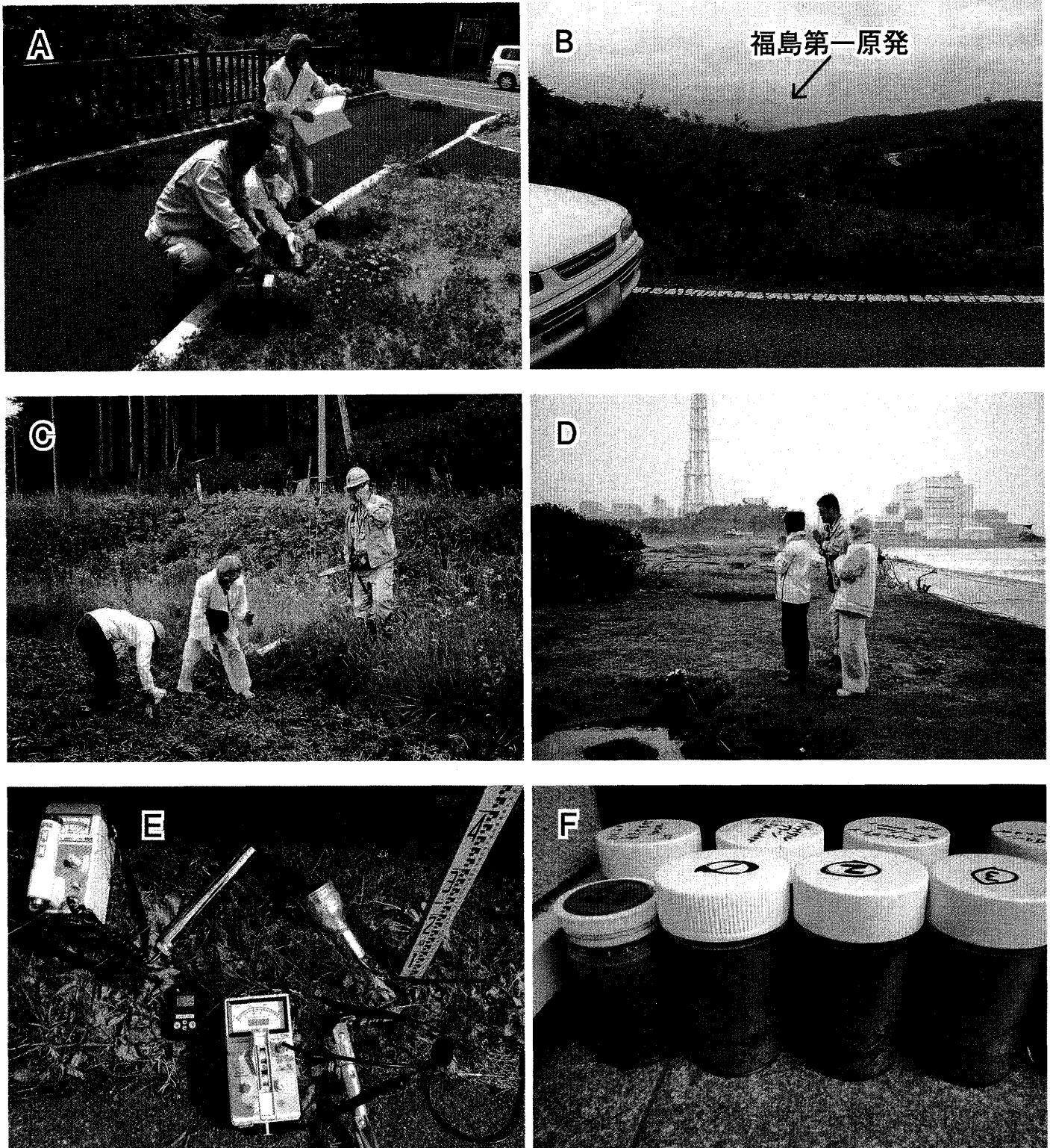
第2図 東日本大震災被災地におけるハンドボーン方式による \beta 線測定地点の状況 (2011年5月31日測定)。
