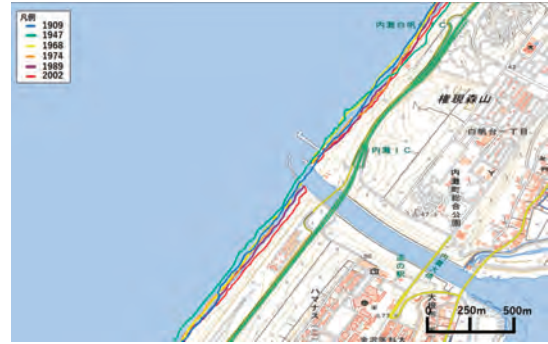
図14 河北潟放水路における汀線の変化。 Fig. 14 Shoreline change of the Kahokugata Floodway.
