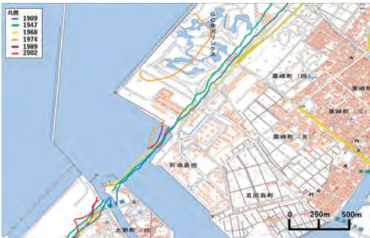
図15 大野川河口部における汀線の変化。 Fig. 15 Shoreline change of the Ohno River estuary.
