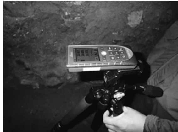
Fotografía 6. Medición preliminar en el sector del colapso del túnel I-27 en Septiembre de 2017.
