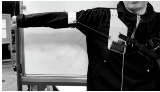
図3 被験者による肩関節可動域測定の一例 ( \beta 方向)
