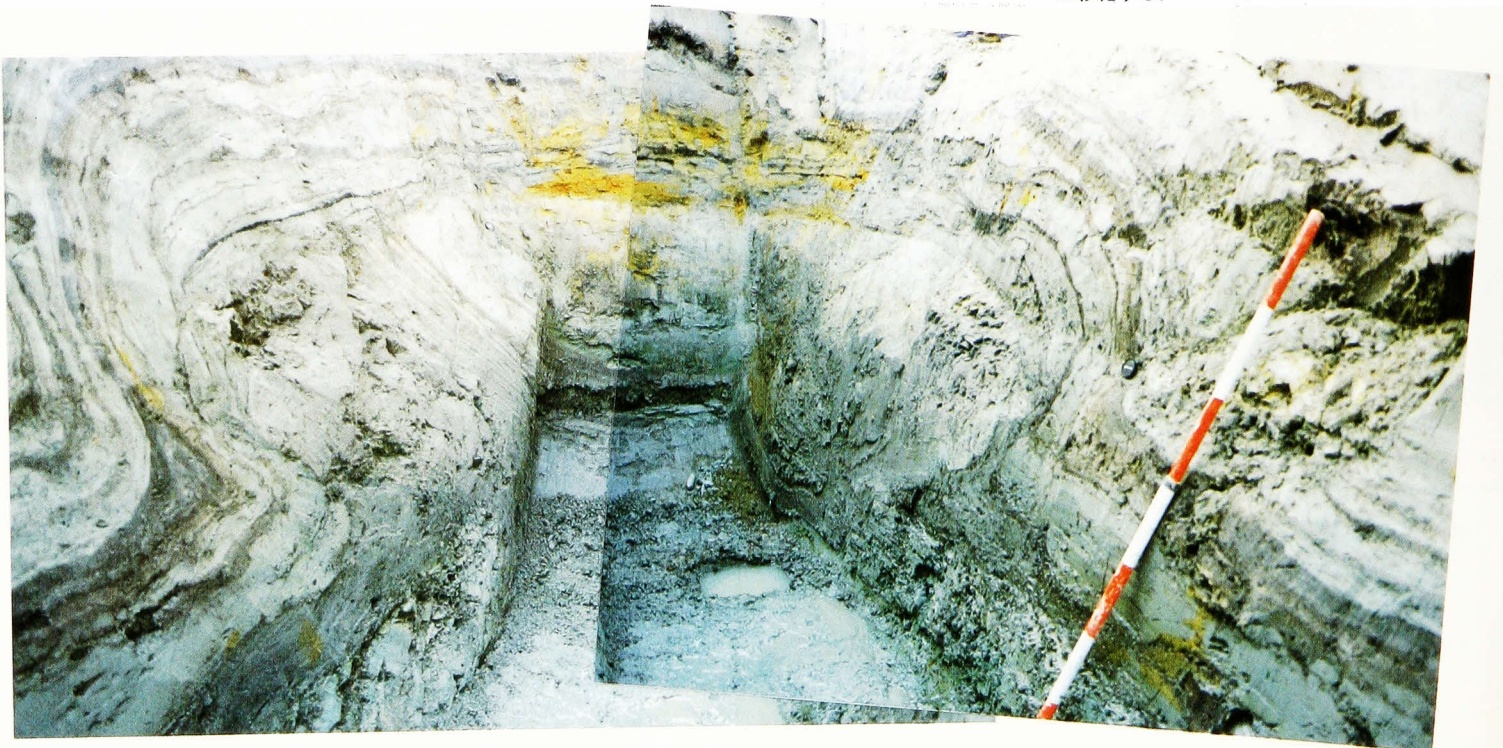
第5図. トレンチの北側壁面にも同様の断層と褶曲構造が露出する。
