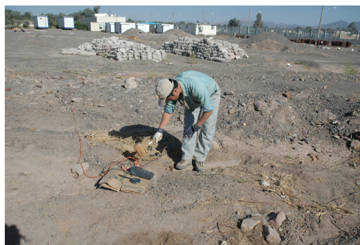
写真 1 弾性波探査実施状況
