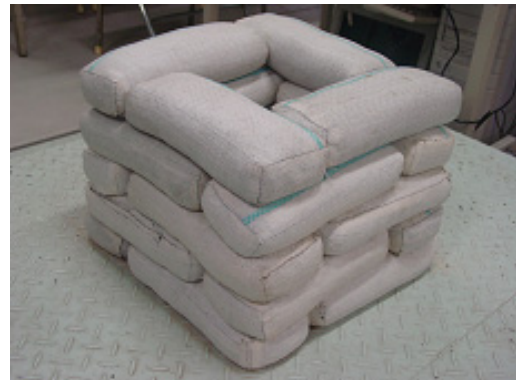
写真-3 土のう型ドレーン材 (5段)
