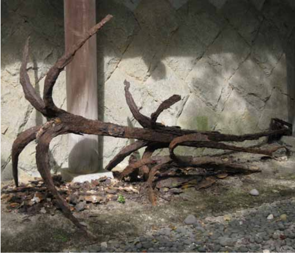
松江市美保関町美保神社境内保管の四爪鉄錨。明治 29 年 (1896) に丹後岩瀧を出港した 20 名乗の船が暴風に会い能登で難船し、流されて美保関に漂着した。年代のわかる四爪鉄錨として貴重である。日本海沿岸の海底から引き揚げられる四爪鉄錨は同じ種類のものが大部分を占め、比較的大型のものは 19 世紀が中心であると思われる。
