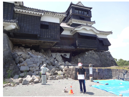
写真-1 熊本城内における常時微動計測の実施状況の一例
