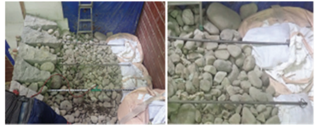
(a) 鉄筋挿入部分 (b) 拡張部分 写真4 鉄筋挿入アンカー工法モデルの状況
