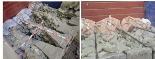
(a) ウレタン注入部分 (b) グラウト部分 写真5 筒状固結体アンカー工法モデルの状況
