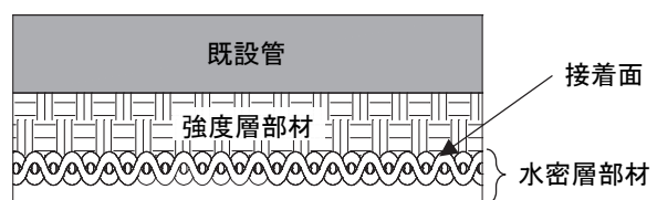
図-12 自立型更生管の断面図
