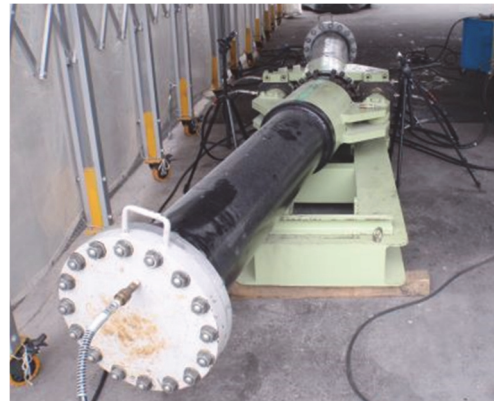
図-15 曲げ実験状況 (曲げ角度 16°)
