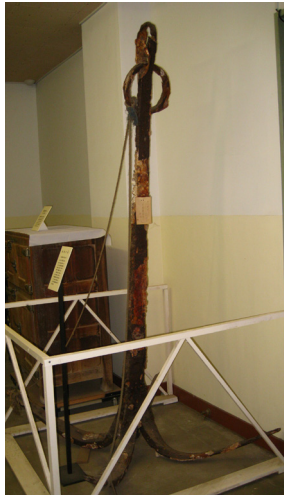
Fig. 35 恵山沖海底引き揚げ4爪鉄錨。函館市立博物館蔵。長さ240cm。
