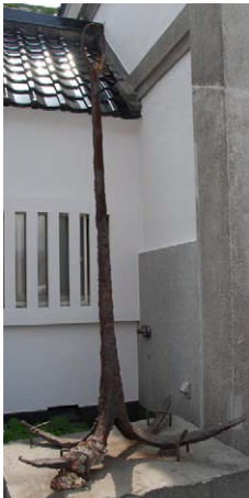
Fig. 37 函館沖海底の海揚げり4爪鉄錨。函館市高田屋嘉兵衛資料館展示品。長さ235cm、225cm、200cm、170cm、112cm、90cmの6点。
