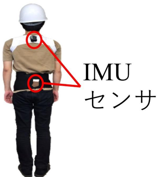
図 3 - 2 IMU センサを腰と肩に取り付けられた被験者の画像 .
