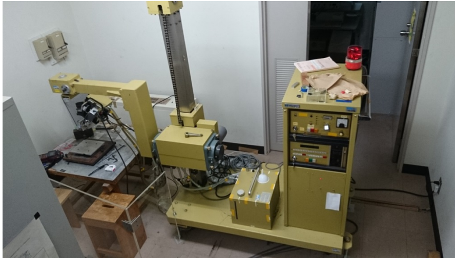
図 3.3 \sin^2\psi 法の X 線応力測定装置 MSF-2M (リガク社)
