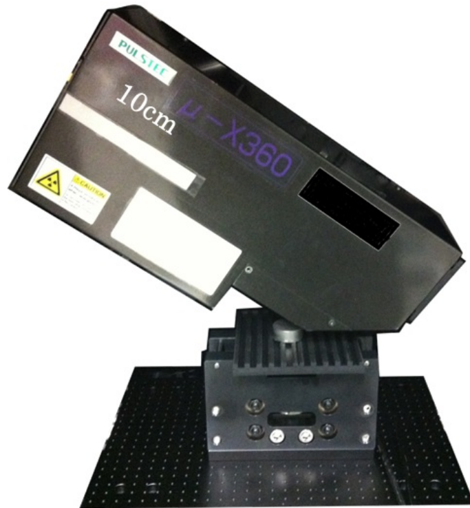
図 3.5 \cos\alpha 法の X 線測定装置 \mu -X360(パルステック社)
