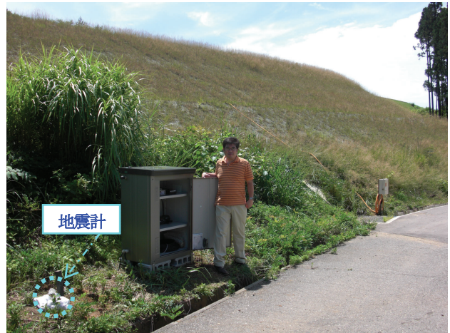
写真-3 地震観測状況(盛-10での例)
