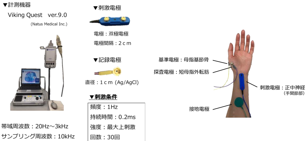
図 3. F 波計測機器および電極貼付位置
